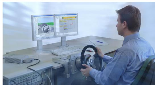
Bei Hinzunahme des Feedback-Lenkrades agiert der Entwickler selbst als Fahrer. Dies ermöglicht in der HiL-Simulation über die haptische Rückmeldung des Lenkmomentes die Vorabstimmung des Algorithmus zur Ermittlung des Handmomentes und damit des Lenkgeföhls bereits vor der Durchführung von Fahrversuchen. Das Ergebnis dieser Arbeit am HiL-Simulator sind unter anderem Unterstützungskennlinien für verschiedene Fahrzeuggeschwindigkeiten.
